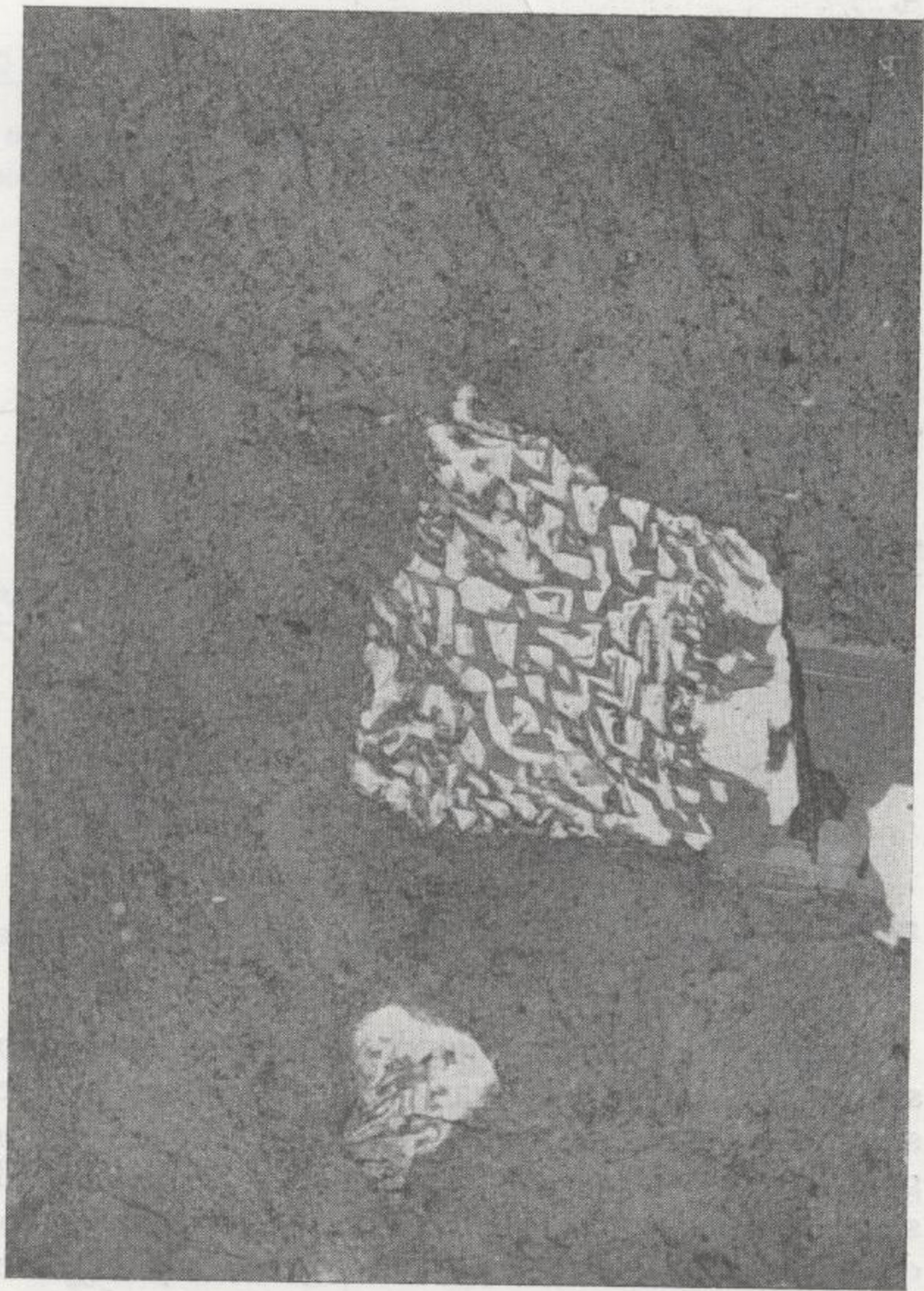
Fig. 5.—Muestra núm. 2. Matriz de feldespato potásico con secciones de micropertita. NX ( \times 40 ).
